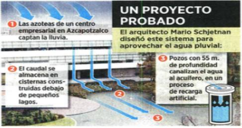
que, en forma paulatina, con un filtro intermedio, conducen el agua a pozos de absorción de 30 centímetros de diámetro y 55 metros de profundidad.
