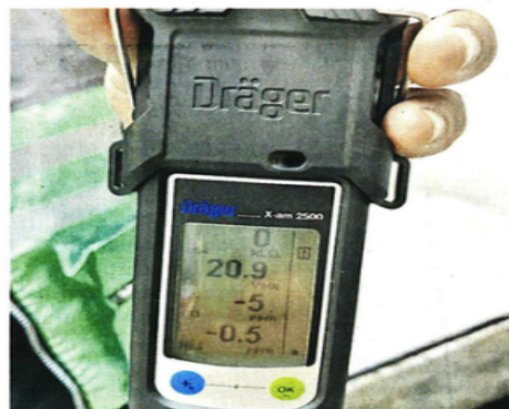
Tres veces al día, miden el riesgo de explosividad en domicilios.
