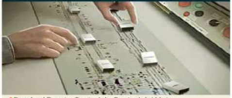
Desde el Puesto Central de Control del Metro, los controladores acomodan las fichas de dominó para simular el desplazamiento y localización de trenes, conforme la indicación del conductor. Así calculan las distancias entre convoyes para evitar accidentes.
