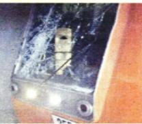
El impacto de un cable produjo que se estrellara el parabrisas de un tren.
