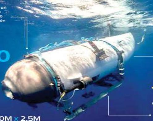
**Titán**, el sumergible tripulado, cuenta con un sistema de monitoreo que detecta en tiempo real cambios de presión y fallas en la nave.
