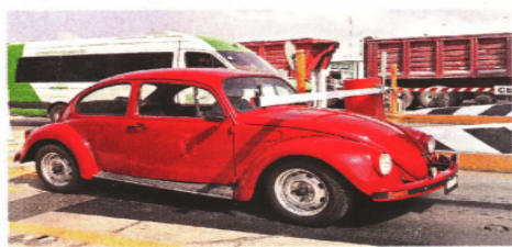
En la punta de la pluma fue colocado un pedazo de fomi para no rayar o dañar los vehículos que la empujan.
