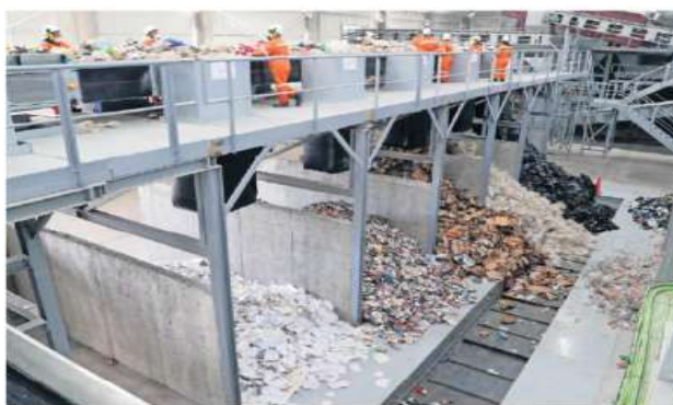
En la planta de selección se separan los residuos urbanos en tres vertientes diferentes que son aquellos que son recuperables, el Combustible de Residuos (CDR) y material orgánico.
