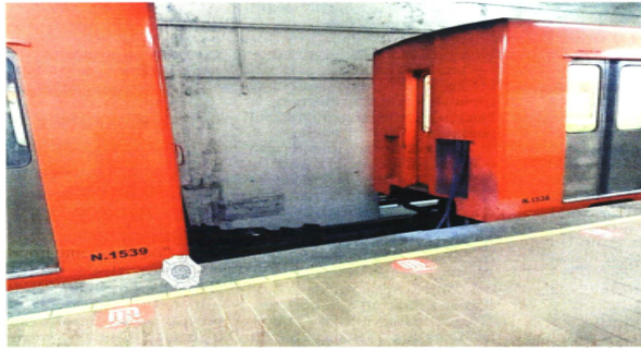
El desprendimiento de vagones en Polanco (L7) se debió a que el tornillo izquierdo de sujeción en el enganche del carro N1537 fue manipulado, determinó la FGJ.
