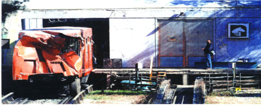
El operador del tren 24 debía conducirse de forma manual a una velocidad de 15 km en curva, pero iba a 45 km: peritaje.
